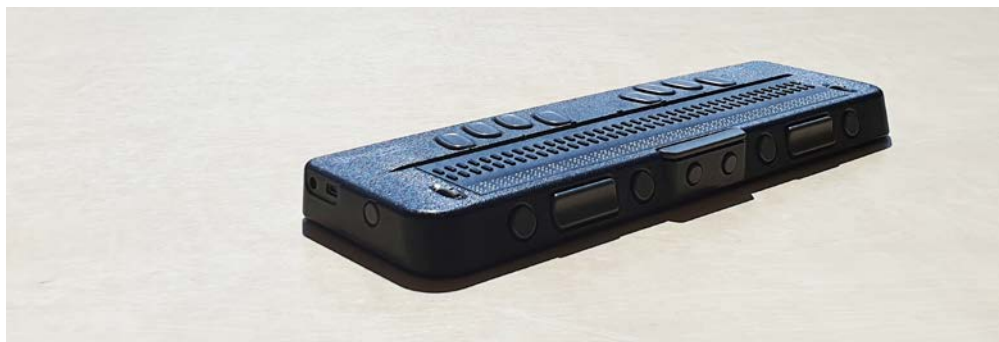
Fot. 4 Monitor brajlowski – widok z boku. Dolna część pozwala na uwypuklenie znaków alfabetem Braille'a. Górne klawisze pozwalają na zapis znaków alfabetem Braille'a.
